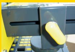
Doppelte seitliche Führungsrollen mit verstellbarer Fixierung...
