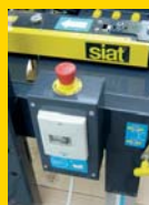
Alle Bedienelemente können wahlweise rechts oder links angebracht werden.
